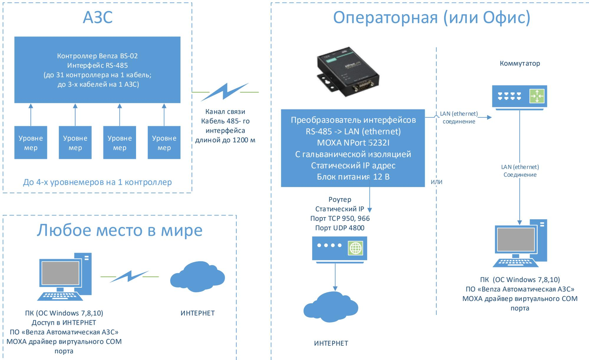
Схема подключения контроллера Benza BS-02 К серверу БД без участия GSM-сервера
